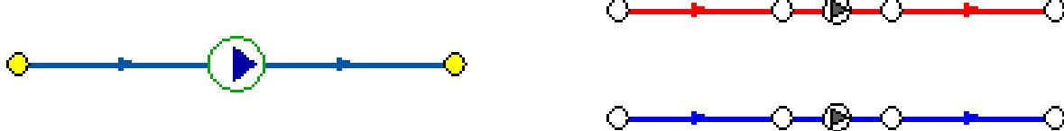
Насос можно моделировать двумя способами: либо как идеальное устройство которое изменяет давление в трубопроводе на заданную величину, либо как устройство, работающее с учетом реальной напорно-расходной характеристики конкретного насоса.
