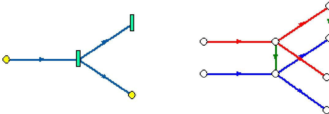
Так как перемычка в однолинейном изображении представлена узлом, то для моделирования соединения между подающим трубопроводом одного участка и обратным трубопроводом другого участка одного элемента «перемычка» недостаточно. Понадобятся еще два участка: один только подающий, другой - только обратный.
