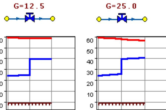
На рисунке показано, что при увеличение в два раза расхода через регулятор, установленный в обратном трубопроводе, давление в регулируемом узле остается постоянным.
