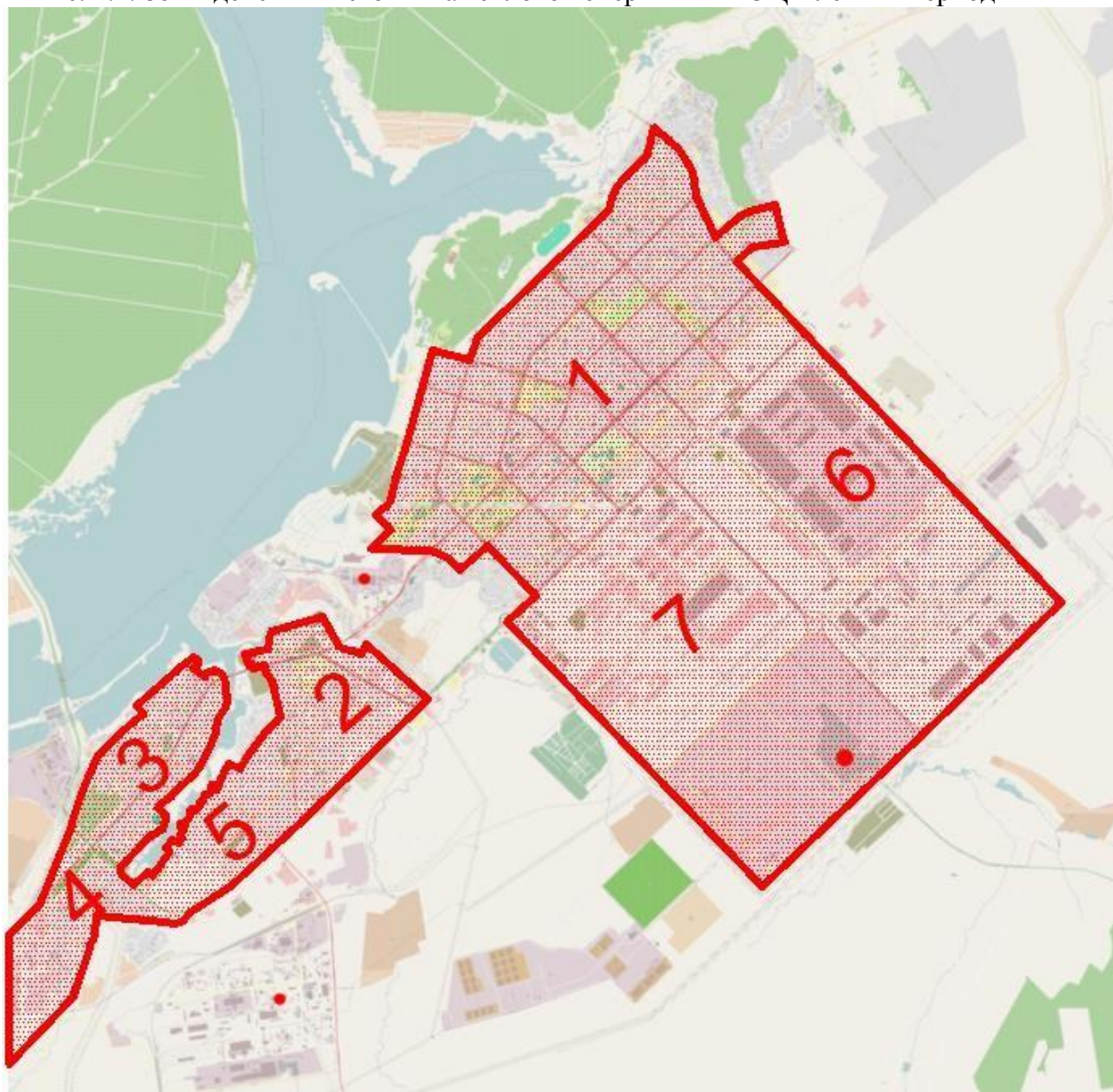
Рис. 4.2. Зоны действия источника тепловой энергии Нч ТЭЦ в зимний период
