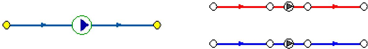
Насос можно моделировать двумя способами: либо как идеальное устройство которое изменяет давление в трубопроводе на заданную величину, либо как устройство, работающее с учетом реальной напорно-расходной характеристики конкретного насоса.
