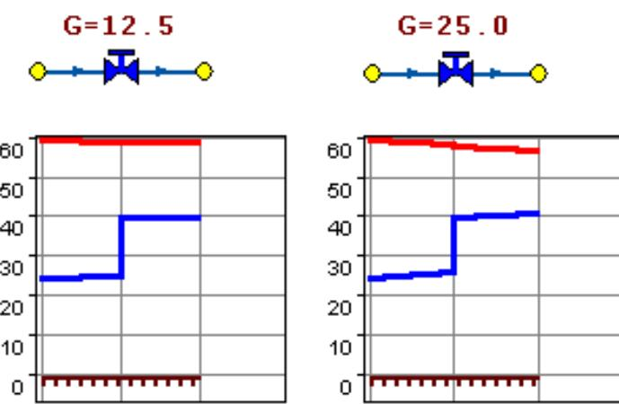
На рисунке показано, что при увеличение в два раза расхода через регулятор, установленный в обратном трубопроводе, давление в регулируемом узле остается постоянным.
